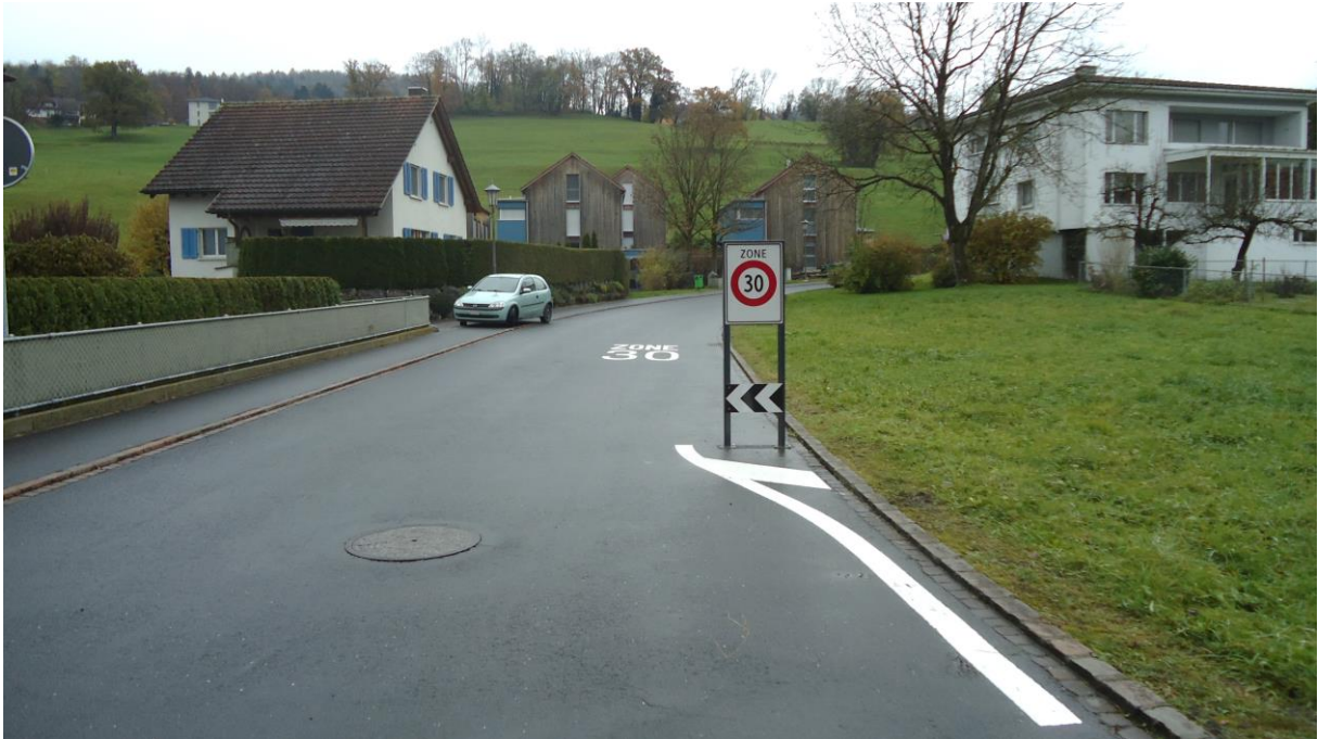
Abb. 7: Beispiele für die Gestaltung einer Torsituation am Beginn einer Tempo-30-Zone
