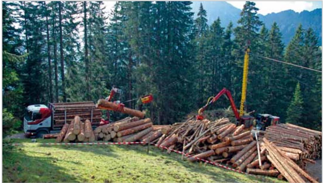
Moderne Holznutzung mittels Seilkran im Schließwald (Bürserberg).
