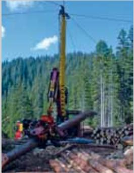
Entasten, ablängen und sortieren mit einer Maschine.
